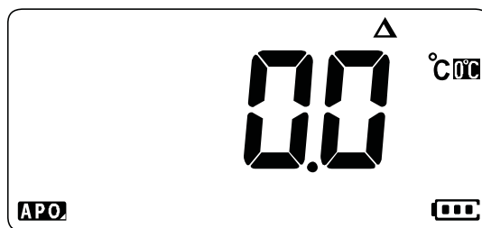
図 2-21 周囲温度補正なしの温度測定
